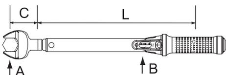
Variables que afectan a la precisión del cálculo anterior: longitud del adaptador o extensión, longitud de la llave y variaciones en la posición de las manos.
