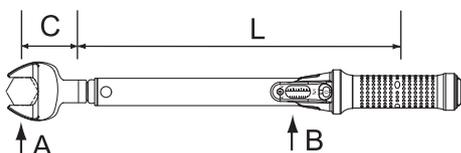
De nombreux facteurs influent sur l'exactitude du calcul ci-dessus : la longueur de l'adaptateur ou de l'extension, la longueur de la clé et également les différentes positions de la main sur la clé.
