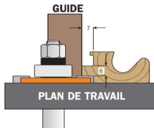
**Etape 4:** Abaisser de nouveau la fraise disque avec le guide toujours à une profondeur de 7 mm, de façon à obtenir un tenon de 6 mm d'épaisseur.
