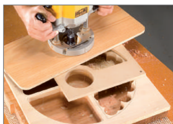
Termine el trabajo utilizando la fresa para bandejas insertada en el mandril.
